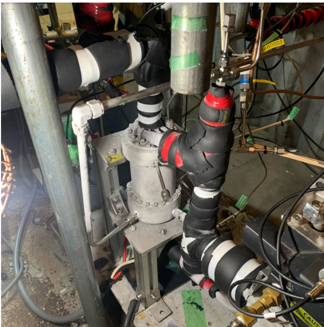
燃焼スタンドに設置された電動ターボポンプとポンプ吸込口
