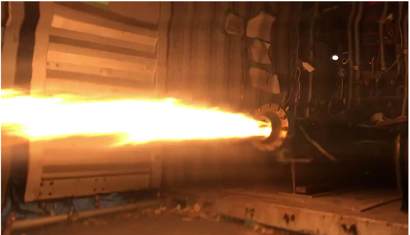
電動ターボポンプを用いた燃焼試験の様子
