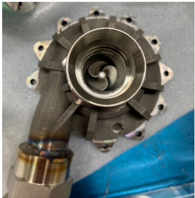
燃焼スタンドに設置された電動ターボポンプとポンプ吸込口
