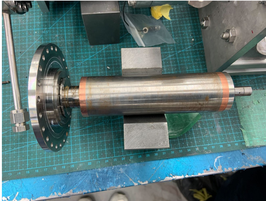
燃焼試験後のシャフト
